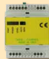
CENTRALINA DI COMANDO CON INGRESSO PER I 2 REGOLATORI DI LIVELLO E SINGOLA USCITA IN COMMUTAZIONE, FINO A 2HP 220V c.a. 50 HZ. PANEL WITH INPUT FOR 2 LEVEL REGULATORS AND SINGLE CHANGE OVER OUTPUT, UP TO 2HP 220V a.c. 50 HZ.
